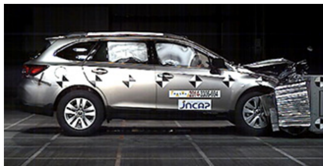
レガシィアウトバックのJNCAPオフセット前突試験画像 提供：自動車事故対策機構
