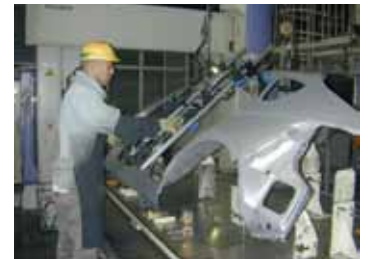
アシスト装置設置後の作業
