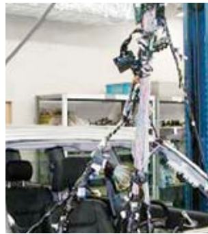
ワイヤリングハーネス類の解体性向上
