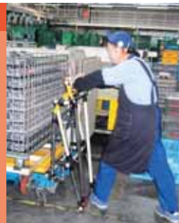
アシスト機能を設置した台車
