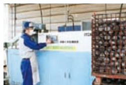
廃棄物削減と収益向上の両方を担う研磨くず処理装置
