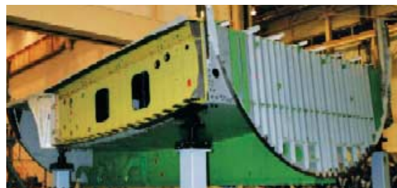
ボーイング787の中央翼。2007年1月12日に初号機が納入されました。
