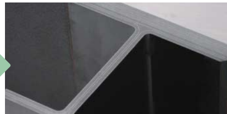
オートクレーブで成型された部品の断面の例。炭素繊維が積み重なった部分が層となって見えます。
