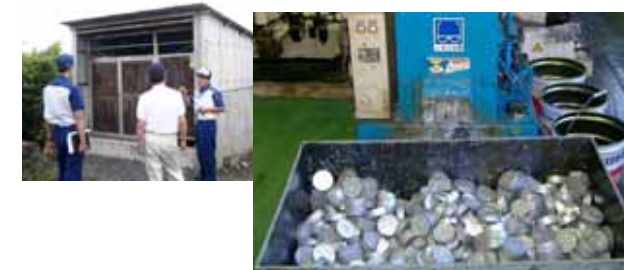
取引先環境パトロールの様子 ((株)サンテクノロジー) 廃棄物の減容と処理コスト削減に貢献する切粉圧縮装置
