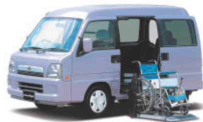
サンバーディアスワゴン トランスケア 電動リフター
