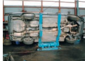
自動車を傾げることで、部品を安全に効率よく外すことができます。廃車解体用転倒機「てんとう虫」本体
