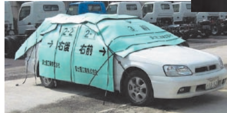
遮音シート取付状態
